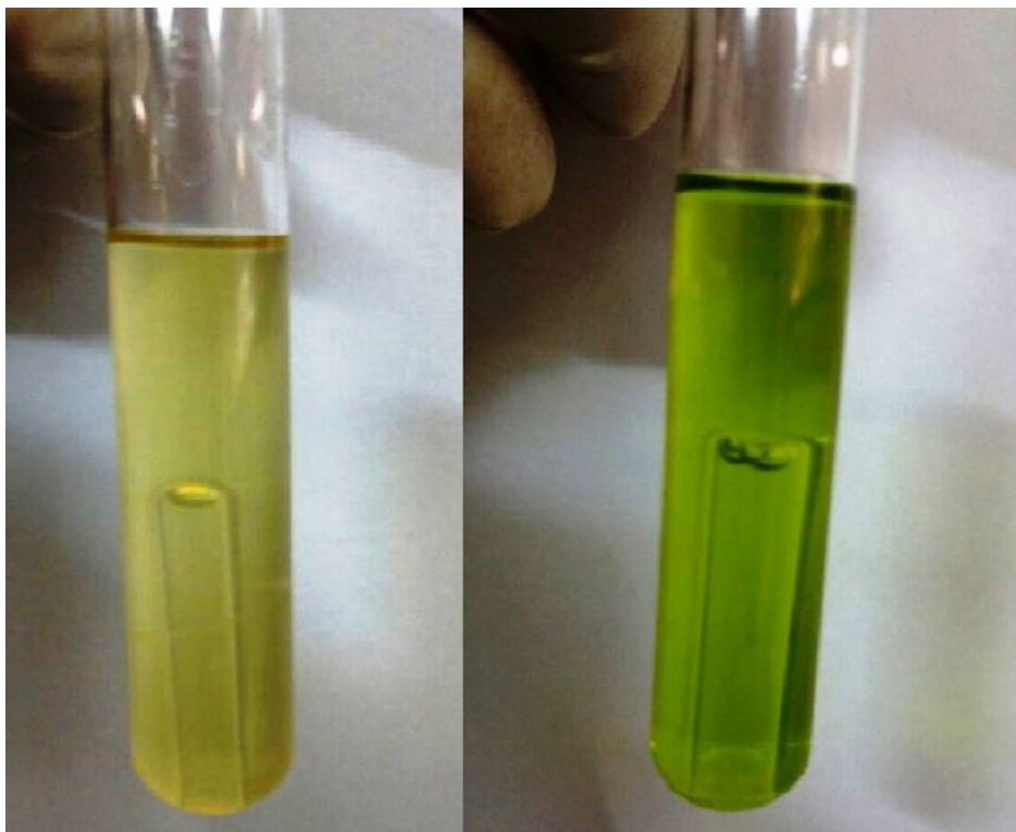
Figura 10. Caldo Lactosado e Escherichia coli (EC) e Caldo Lactose Bile Verde Brilhante (VB) após receber as diluições de areia, com produção de gás.
