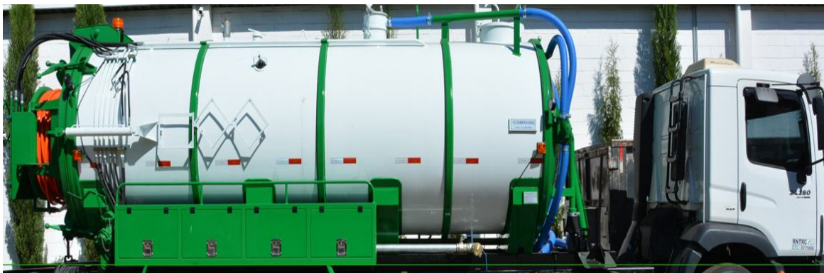
Figura 16: Unidade de blendagem e coprocessamento.
