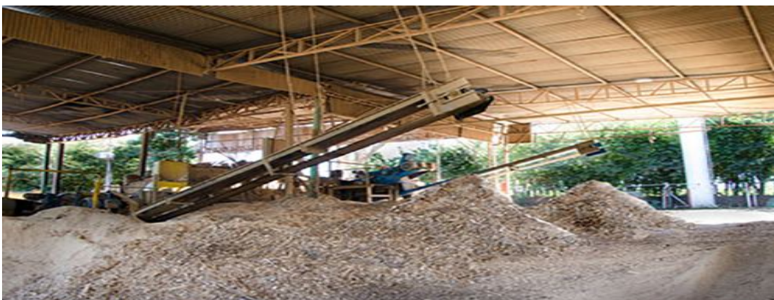
Figura 14: Trituração/Moagem dos resíduos de Mdf/Mdp e madeiras para geração de biomassas. Fonte: Mejan – 2016
