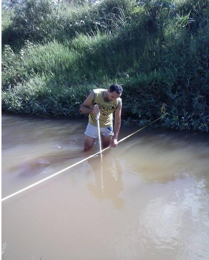
**Figura 4:** Processo de medição da vazão do rio.
