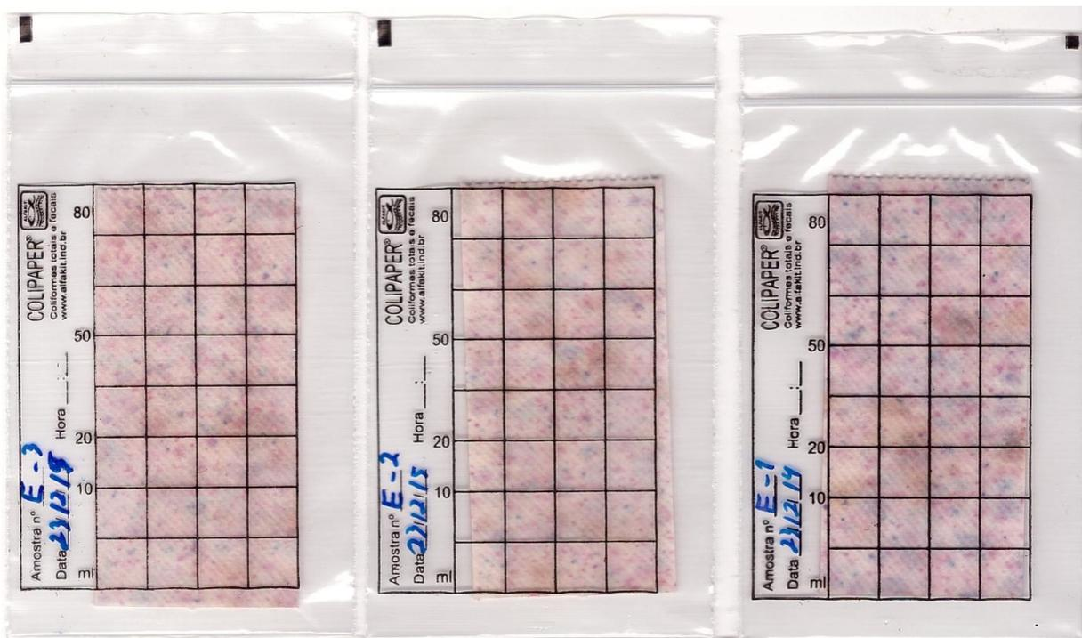
**Figura 5:** Foto representativa das amostras incubadas e com as Unidades Formadoras de Colônia (UFC).
