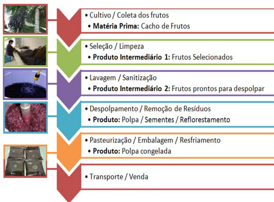
Figura 17: Fluxograma das operações para obtenção dos produtos e subprodutos da polpa do fruto da juçara.
