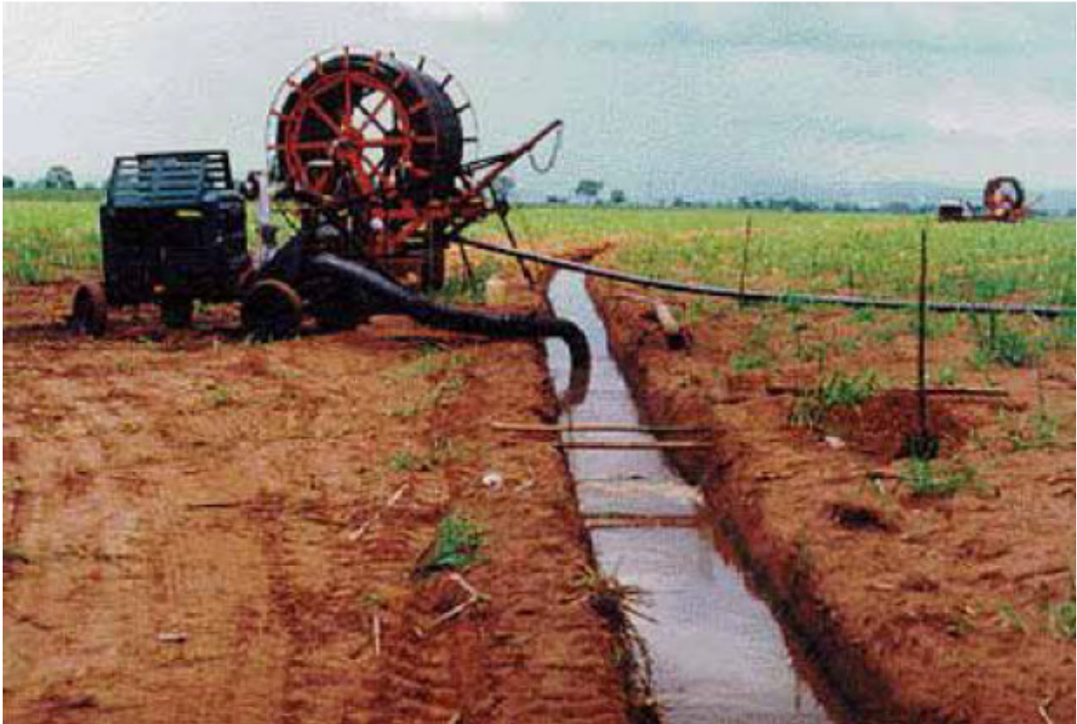
Figura 5 Sistema da aspersão com montagem direta (rolão). Fonte: ANA, 2009.
