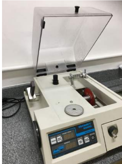
Figura 6. Micrótomo Buehler modelo Isomet 1000 para corte dos blocos ósseos. Fonte: o autor
