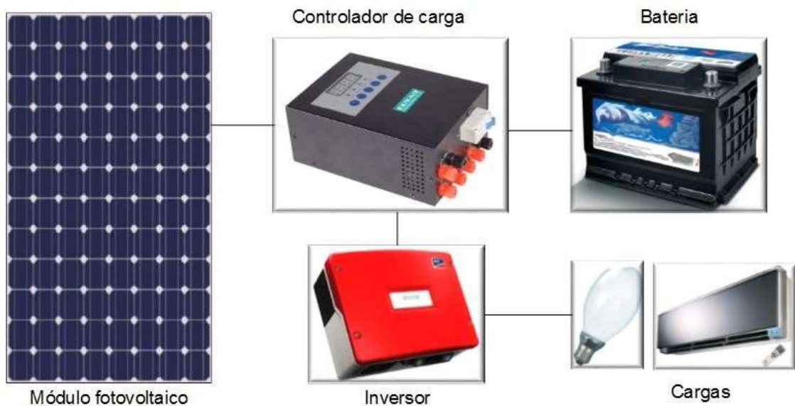
Figura 4 - Componentes do sistema fotovoltaico autônomo [14]
